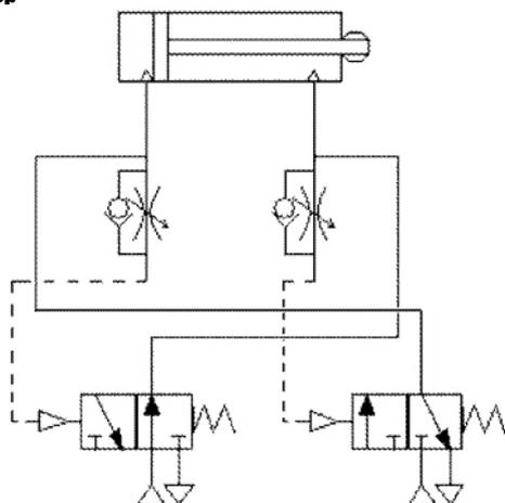
Надежная автоколебательная система с возможностью регулировки частоты и скажности.
