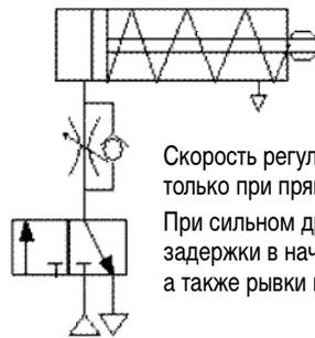
Скорость регулируется только при прямом ходе. При сильном дросселировании возможны задержки в начале движения, а также рывки и остановки поршня.
