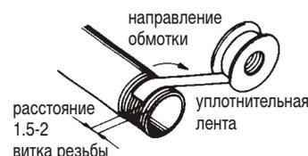
Для получения герметичного соединения необходимо уплотнить наружную резьбу трубопровода тефлоновой лентой, отступив от конца резьбы 1.5-2 витка. Направление намотки тефлоновой ленты должно быть противоположным направлению закручивания подсоединяемого трубопровода.
