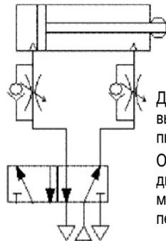
Дросселируется поток, вытесняемый из полости пневмоцилиндра. Обеспечивается равномерное движение поршня, в том числе на малых скоростях и при переменной нагрузке.
