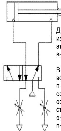
Дросселируется поток, вытесняемый из полости пневмоцилиндра. При этом дроссели установлены в портах выхлопа пневмораспределителя.
